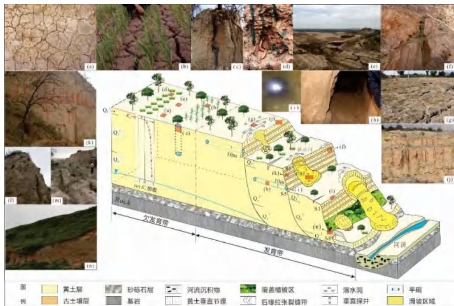
黄土塬边垂直节理的形态特征、发育规律及对塬边侵蚀和滑坡的影响。
