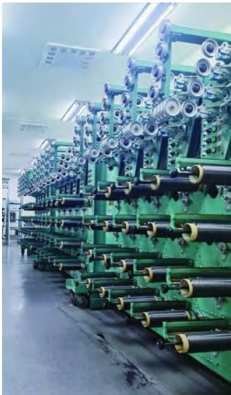
位于扬州的高性能 T300 碳纤维生产线。
