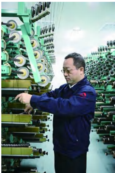
吕春祥在扬州氧化碳化线收丝 工位收丝前剪断丝束
